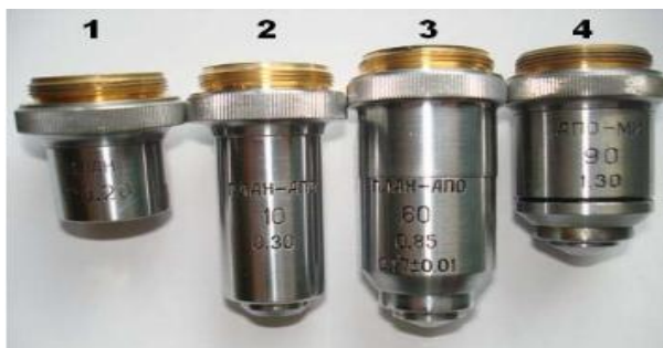
Сурет 1 - Микроскоп объективтерінің түрлері 1 – кіші үлкейтілімдегі планахромат; 2, 3 – планапохроматтар; 4 – иммерсиялық апохромат
