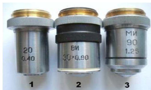
Сурет 2 - Объективтердің сипаттамасы 1 – құрғақ объектив; 2 – сулы иммерсия; 3 – майлы иммерсия
